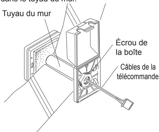
2. Perforez un trou de 32mm (1-1/4") dans le mur là où la télécommande sera installée.
