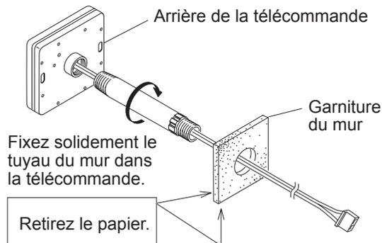
5. Faites glisser l'écrou de la boîte par-dessus les câbles de la télécommande et vissez-le dans le tuyau du mur.
