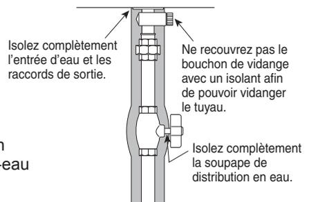
Si l'unité est installée sur un toit pour alimenter en eau les niveaux inférieurs, assurez-vous que la pression de l'eau distribuée à l'unité ne descend pas en dessous de 29psi. Il pourra être nécessaire d'installer un système de pompage pour garantir que la pression de l'eau est maintenue à ce niveau.
