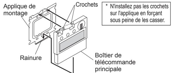
6. Fixez la télécommande en place avec les vis machine.
