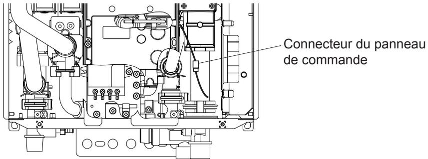
3. Coupez le connecteur à l'extrémité des câbles du panneau de commande et les bornes en forme de Y (deux cordons) du cordon de la télécommande.
