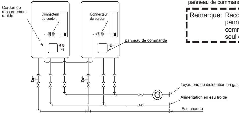
\*1 Lors du raccordement de deux unités, débranchez le connecteur de la panneau de commande de l'autre unité.
