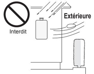
La chaleur et l'humidité du chauffe-eau peuvent provoquer une décoloration des murs et matériaux résineux ou une corrosion des matériaux en aluminium.
